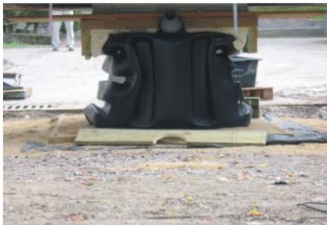
Charge jusqu'à la rupture: 1,9 T
